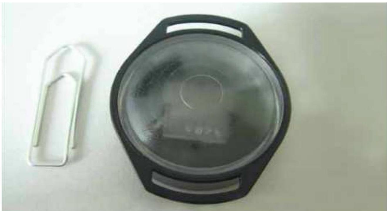
Abb. 7: Kernspurdetektor zur Registrierung von Radon über Zeiträume bis zu einem Jahr [5]
