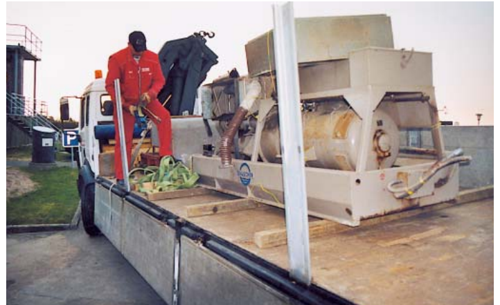
Auf dem Transport: der 1,5 t schwere Generator, der jetzt für Strom im Dom sorgt.
