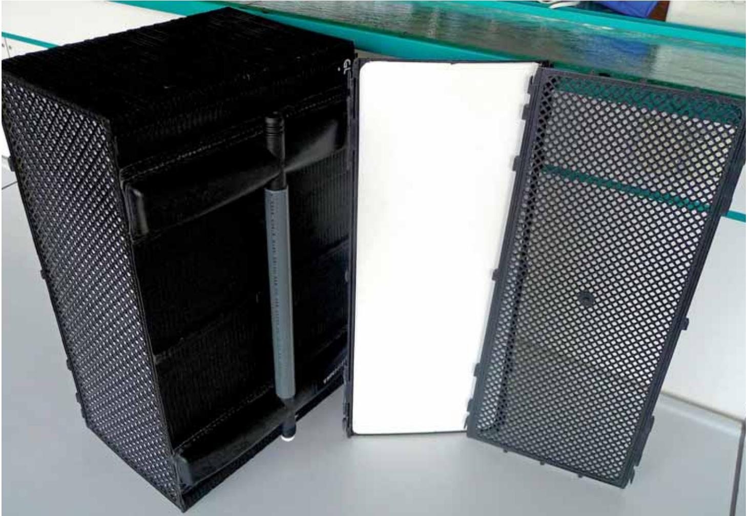
Membranfiltrationsmodul; membranbelegte Einzelplatte; unbelegte Einzelplatte.
